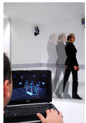
Analyse du mouvement par caméra vicon © Andréa Aubert / CEA
